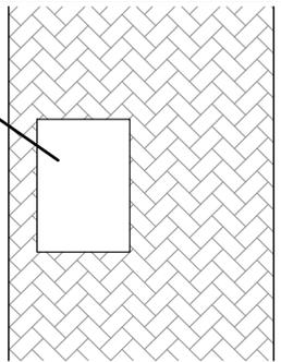
Pozzetto di scarico Art. P-101 CON GRIGLIA
